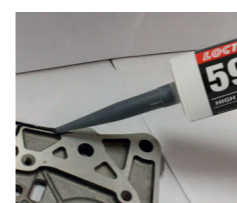
Vedante de silicone de base oxímica, indicado para fazer juntas em qualquer sistema flangeado.
