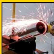
1 Corte de vergalhões, linhas de solda. Esmerilhadeira Angular STGS6115/7115/8115.
