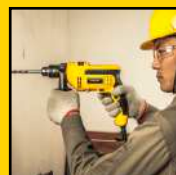
3 Perfuração em alvenaria. Furadeira com Impacto SDH600/SDH700/STDH8013.
