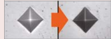
Imagem observada da indentação na peça (50X)
