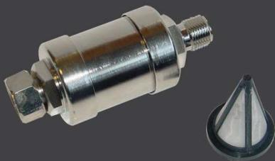
Filtro de tinta para acoplamento entre a saída do tanque de pressão/bomba de diafragma e a mangueira de fluido para filtração de impurezas e partículas. Apresenta elemento filtrante de fácil remoção para limpeza e troca.
