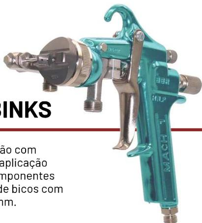
Pistola com dupla atomização com mistura externa. Ideal para aplicação de fluidos e adesivos bi-componentes com curto pot life. Opções de bicos com diâmetros de 1,0 mm a 2,3 mm.
