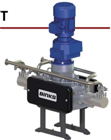
As bombas da série Binks SMART são bombas de pistão que usam motores elétricos padrão para acionar a seção de fluidos para bombear tintas, solventes e outros materiais. As bombas SMART estão disponíveis em diferentes modelos com taxas de vazão de aproximadamente 4 LPM a 60 LPM e pressão de até 290 PSI. Apresentam custos de operação significativamente inferiores aos modelos acionados por ar comprimido.
