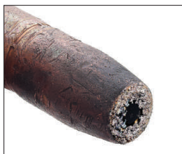
Bocal totalmente entupido (sem proteção E-Weld Nozzle)
