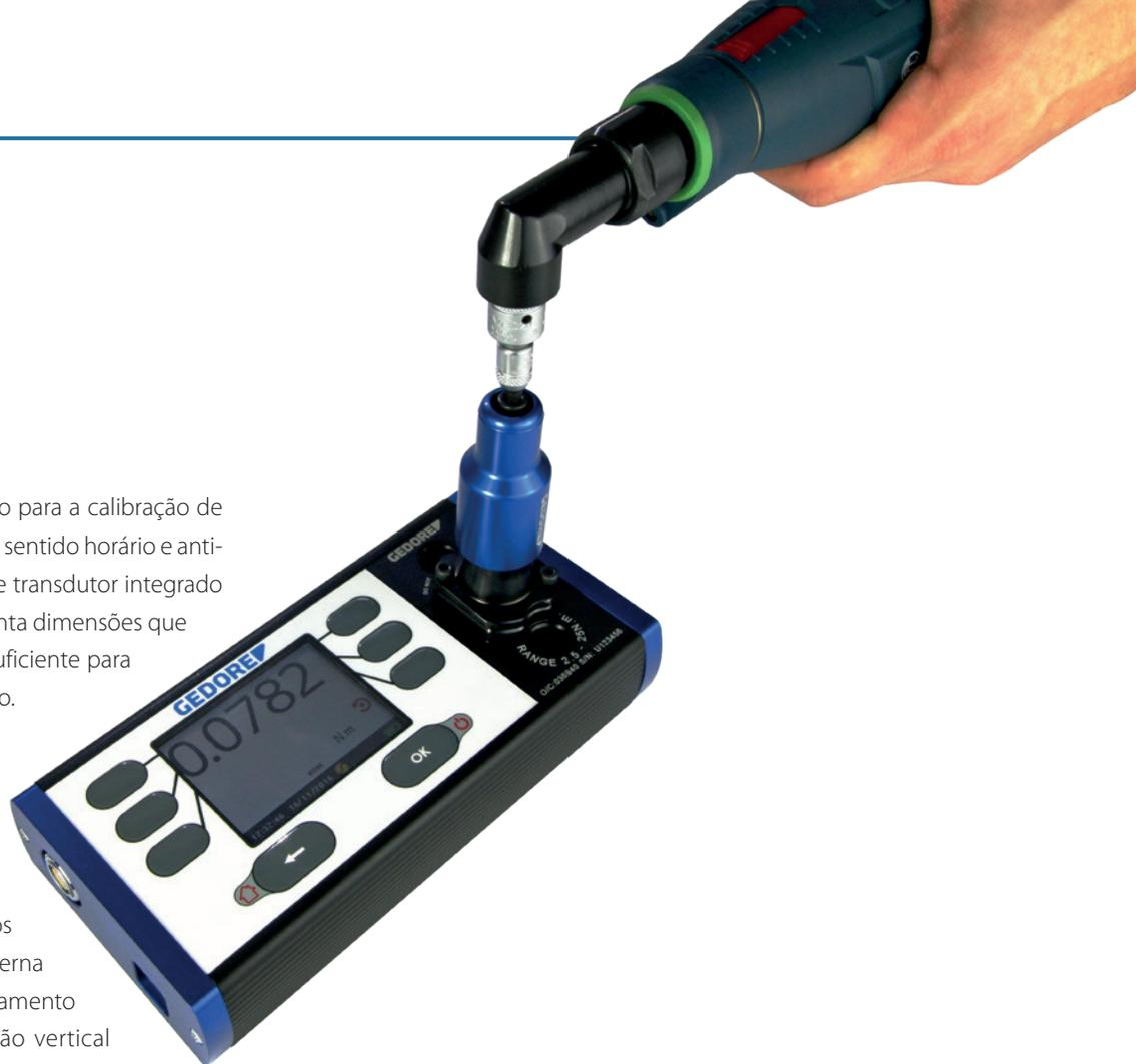
Completa integração com software Capture PC, fornecido separadamente, auxilia no gerenciamento de torquímetros e parafusadeiras elétricas ou pneumáticas, permitindo a rápida análise e armazenamento de dados.
