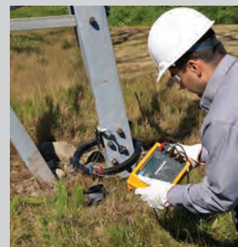
Garra para transformador para medições de loop de aterramento em torres de transmissão.
