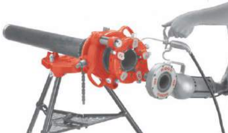
Unidade de Força 700
