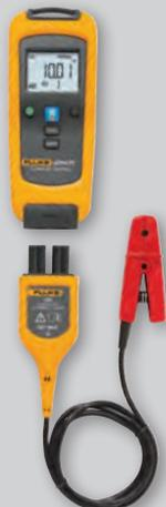
Medidor de corrente sem fio,
