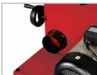
Sistema de liberação de cavaco Sistema de liberación de aserrín
