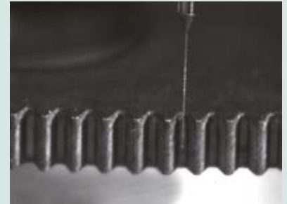
Medição de forma em micro engrenagem
