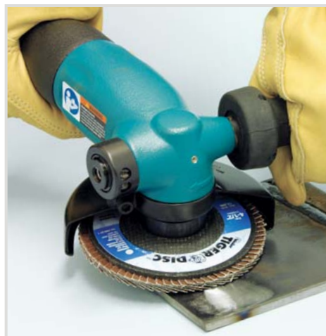
52632 Esmerilhadeira para abrasivos com centro deprimido (ex: Flap Discs).
