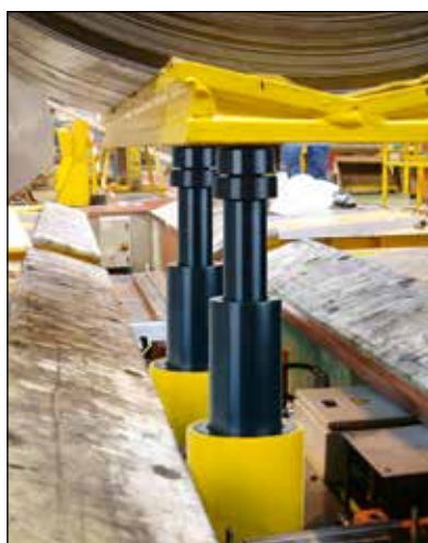
◀ Cilindro de levantamento de aço laminado RT-1510 para posicionamento na armazenagem.
