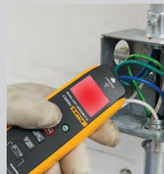
Verifique rapidamente a presença de tensão sem tocar em um condutor energizado.
