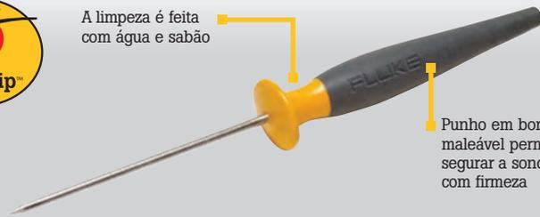
Punho em borracha maleável permite segurar a sonda com firmeza
