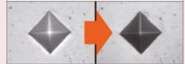
Imagem observada da indentação na peça (50X)
