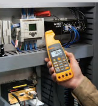
Processo de medição e outras automações de sinais de 4 a 20 mA sem interrupção do circuito.
