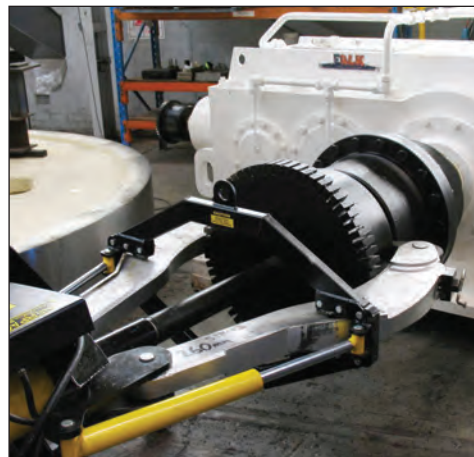
▲ O EPH-1002 remove com rapidez e facilidade esta bucha de seu eixo.
