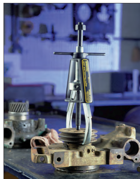
▲ Extrator EP-204 de 2 garras posicionado para remover a polia de uma bomba de água.
