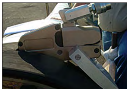
◀ Chave hidráulica de torque customizada com pás de reação para uso em linha de vazão flexível.
