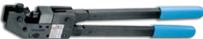
Mecanismo de catraca desenvolvido para crimpagem constante e segura de terminais de cabos não isolados com condutores. Garante ciclos perfeitos e bloqueio forçado. Crimpagem assimétrica para um arremate perfeito. O insertos marcam o conector, permitindo a utilização correta da ferramenta. Braços compridos permitem o uso das duas mãos, exigindo menor esforço para realizar o trabalho.
