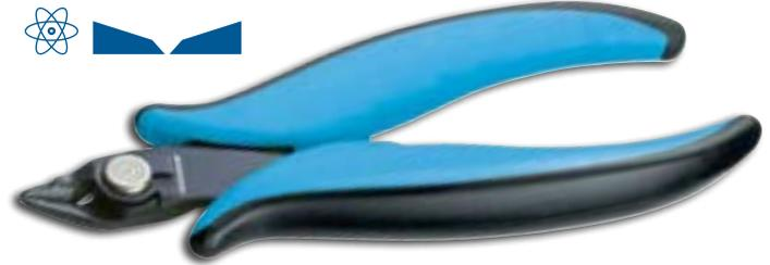
Cabeça larga e pontuda. Corte inclinado (21°), sem chanfro. Com sistema de retenção do fio cortado. Para corte de fio de cobre com diâmetro de até 1,3 mm / AWG 16 e fio de média dureza com diâmetro de até 1,0 mm / AWG 18.
