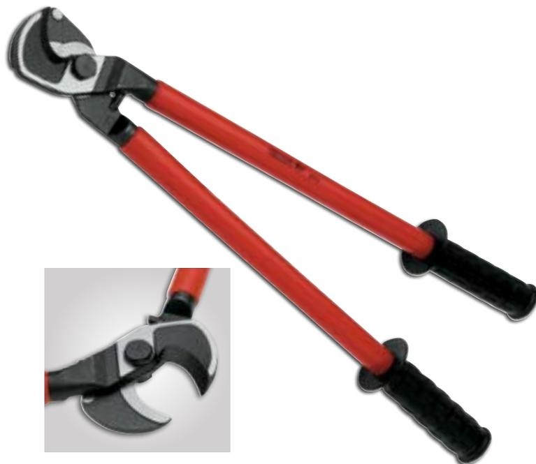
Cabeça em aço especial, com acabamento escurecido. Cabos em tubo de alumínio com revestimento esmaltado a pó, empunhadura ergonômica em borracha. Indicada para corte de cabo de cobre e alumínio com diâmetro máximo de ∅ 27 mm, e seção máxima de 150 mm<sup>2</sup>. Não recomendada para corte de cabos e fios de aço. Nova geometria de corte permite um corte limpo e suave, com o menor esforço do usuário.
