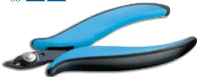
Extra pontudo e com cabeça reduzida. Corte inclinado (21°), sem chanfro. Com trava e sistema de retenção do fio cortado. Para corte de fio de cobre com diâmetro de até 1,0 mm / AWG 18.
