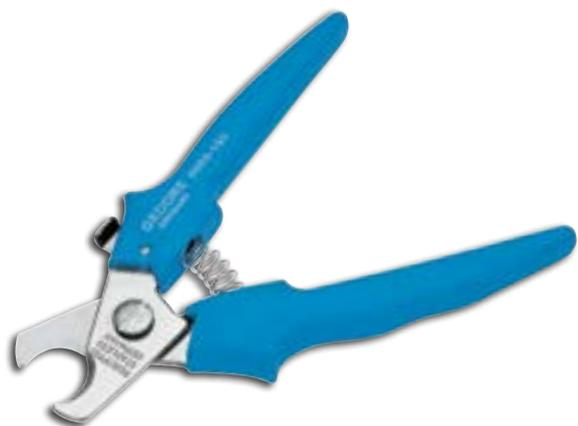
Cabeça em aço inox e empunhadura ergonômica em polímero na cor azul padrão Gedore, resistente a impactos. Abertura automática e fechamento prático, através de mola. Possui sistema de corte tipo guilhotina. Indicada para cortar cabos de cobre e alumínio com seção máxima até 10 mm<sup>2</sup>.
