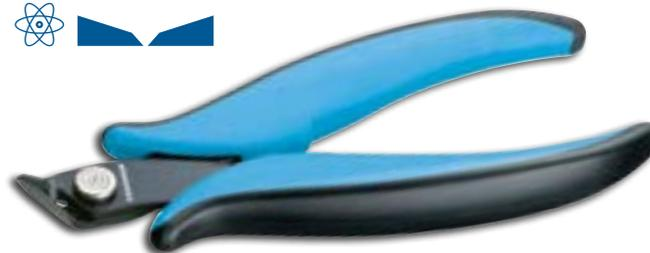
Cabeça larga e pontuda. Corte inclinado (48°), sem chanfro. Para corte de fio de cobre com diâmetro de até 1,3 mm / AWG 16.
