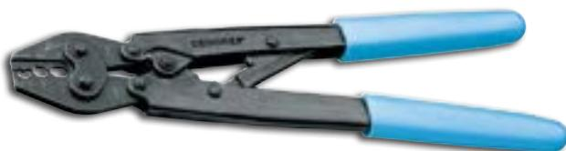
Mecanismo de catraca desenvolvido para crimpagem constante e segura de terminais de cabos não isolados com condutores. Garante ciclos perfeitos e bloqueio forçado. Crimpagem assimétrica para um arremate perfeito. O insertos marcam o conector, permitindo a utilização correta da ferramenta. Braços compridos permitem o uso das duas mãos, exigindo menor esforço para realizar o trabalho.
