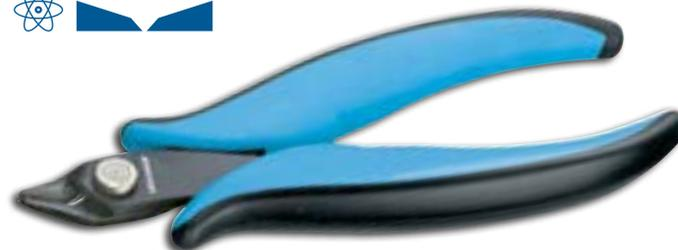
Cabeça larga e pontuda. Corte inclinado (21°), sem chanfro. Para corte de fio de cobre com diâmetro de até 1,3 mm / AWG 16 e fio de média dureza com diâmetro de até 1,0 mm / AWG 18.
