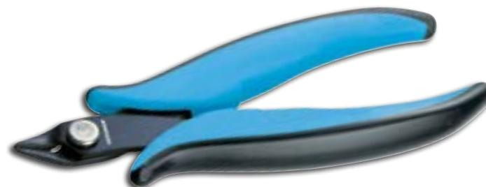
Cabeça larga e pontuda. Corte inclinado (21°), sem chanfro. Para corte de fio de cobre com até 1,3 mm / AWG 16 de diâmetro.
