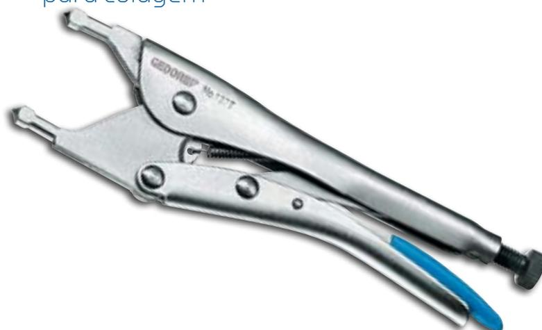
Utilizado para unir peças que serão coladas. Com as pontas do alicate marcar as posições dos furos das peças que serão coladas. Com um furador fazer furos com diâmetro de 9 a 10 mm. Passar cola, aproximar as peças, colocar o alicate sem a trava nos furos e depois acioná-las. O alicate aperta ou fixa, sem esforço do operador, peças que possuam abas, perfis em curvas ou ângulos, corrimões e janelas.
