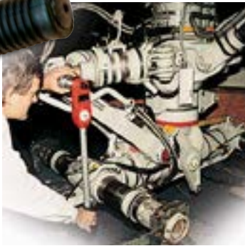
Um torquímetro CDS sendo usado no trem de pouso de um avião Boeing
