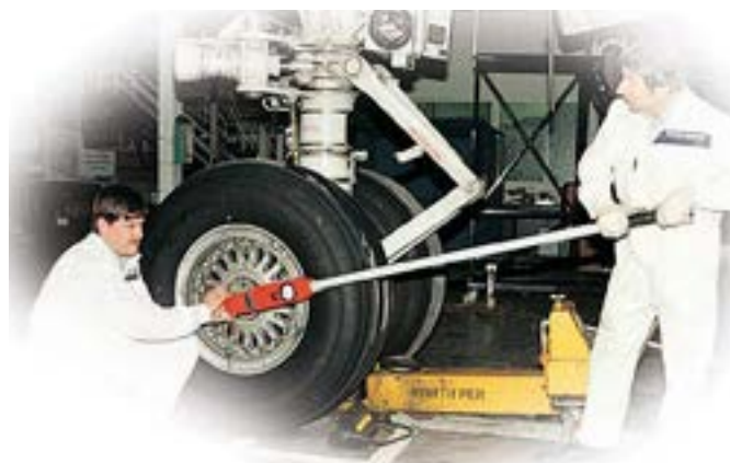
Um torquímetro EDS sendo usado na montagem da barra da roda (do nariz) de um avião Boeing
