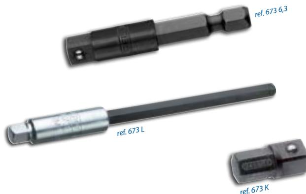
Aço Gedore-Vanadium. Ref. 673 6,3 e 673 K com acabamento escurecido. Ref. 693 L possui corpo com acabamento escurecido e encaixe quadrado niquelado e cromado. Encaixe hexagonal conforme norma DIN 3126
