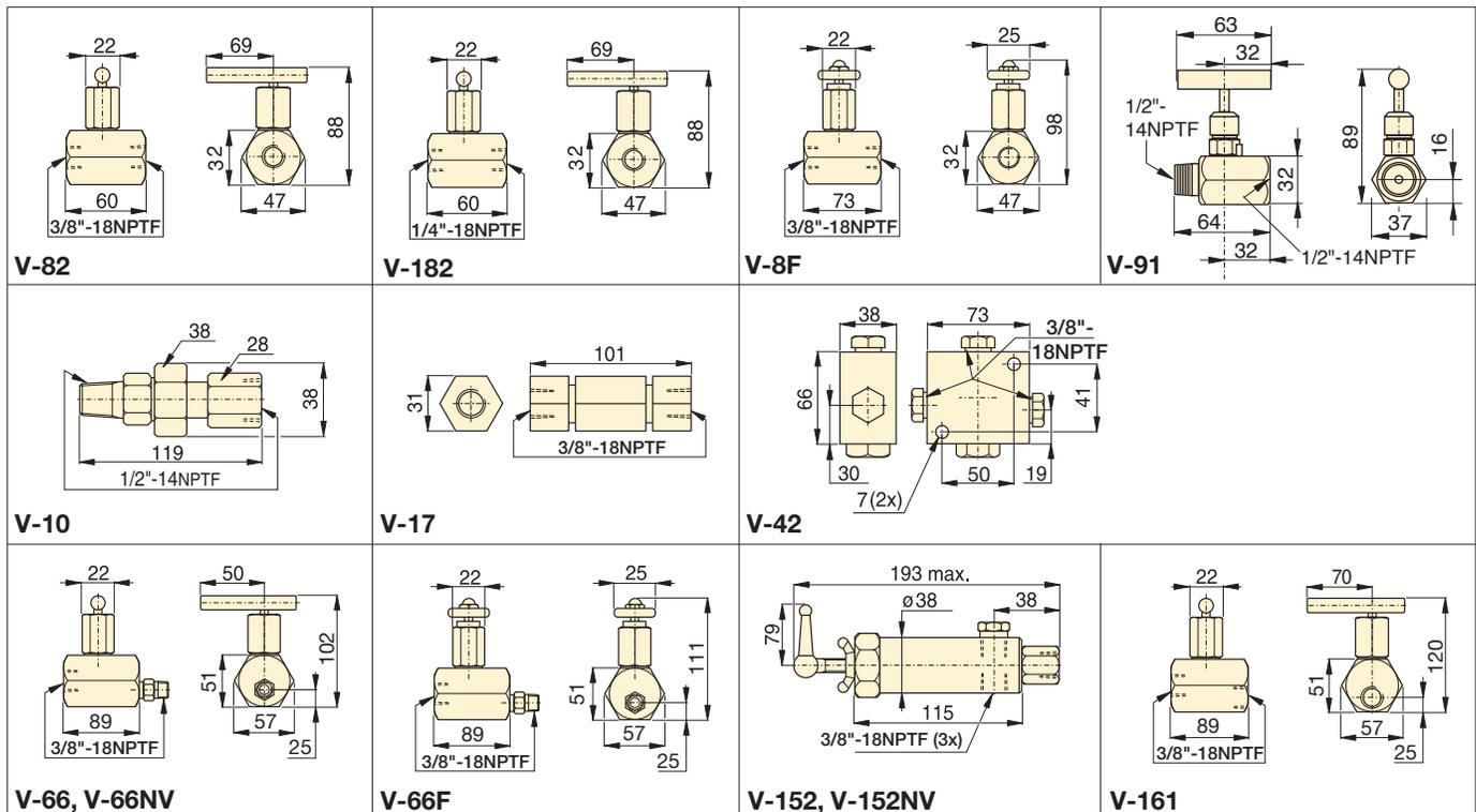
Dimensões das Válvulas em milímetros.
