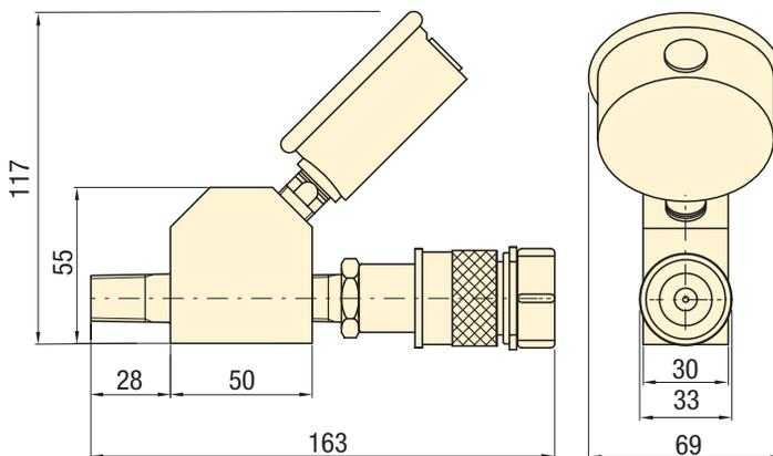
▼ A montagem com manômetro e adaptador é a janela para o seu sistema; facilita a leitura de pressão para uma operação segura.
