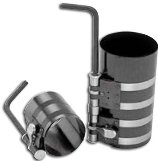
Aço mola especial. Abraçadeira: fosfatizada. Eixo: niquelado e cromado. Utilizado para montagem do pistão com anéis no cilindro.
