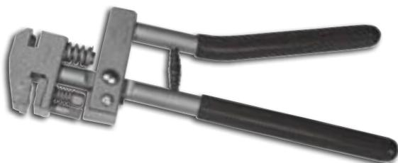
Alicate combinado para rebaixar e furar (Ø 5 mm) em bordas de chapa de aço de até 1mm de espessura. Possui cabeça giratória, desta forma permite executar as duas operações em seqüência (rebaixar e furar) com pouco esforço.
