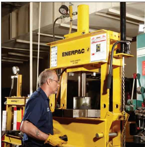
◀ Uma prensa Enerpac com armação tipo H agiliza o trabalho de remoção de um eixo nesta montagem.
